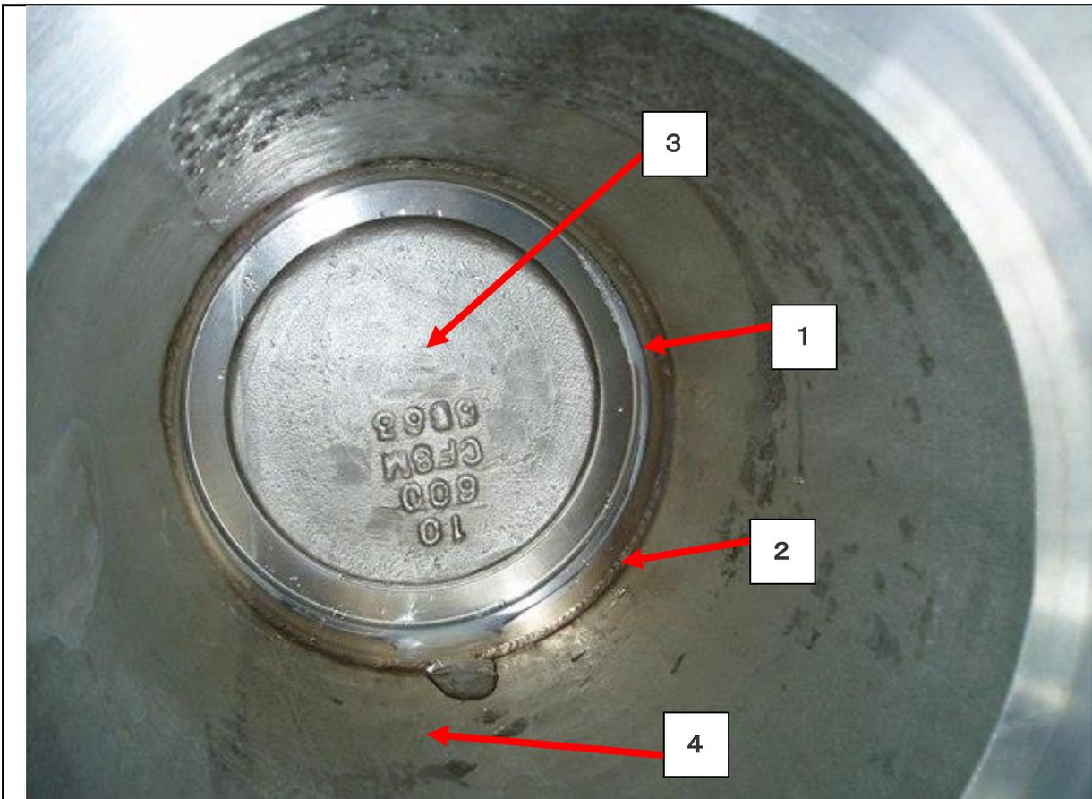
この写真は、Gate Valve に試験流体ヘリウムで High-Pressure Closure Test の試験圧力を加え、全閉後、片側を大気開放状態にし、発泡剤を塗布した状態です。
