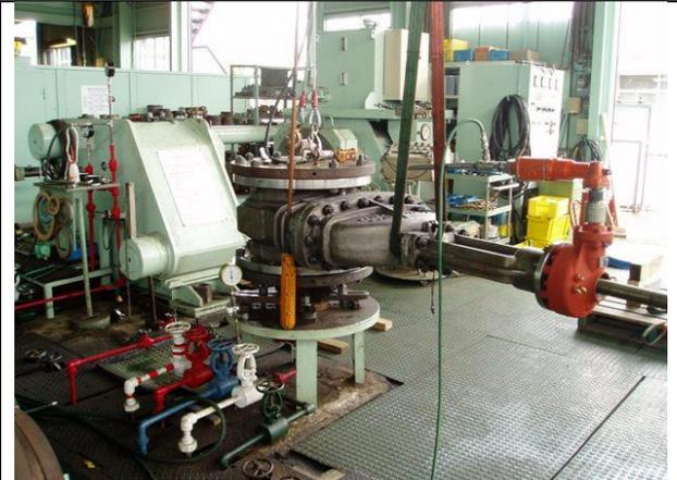
この写真は、プレスで固定できないような大口徑高圧バルブで BW 部に試験治具を挿入し、クランプ方式でフランジを固定した方法。
