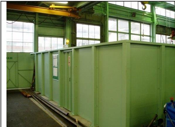
最近では欧米を中心に HSE(Health, Safety and Environment) MANAGEMENT が普及し、圧力試験設備の周りを防護壁で囲うことが要求される。左の写真はその一例である。
