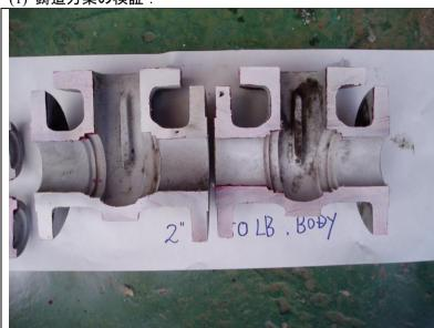
初回鋳造品等は、鋳造部品を切断 して、内部欠陥の確認及び各部分 の寸法を測定する場合がある。 Shell Mold 及び Lost Wax 法のよう に比較的量産の鋳造品に対しては 有効な方法の一つです。
